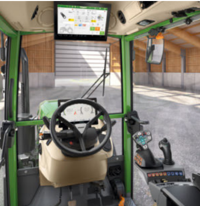
Profi Setting 2 - 3L joystick - 2 linearmoduler (vippeknap) til styring af hydraulikventiler - 12" terminal
