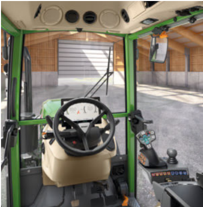
Power Setting 2 - Krydshåndtag - Intet linearmodul (vippeknap)
