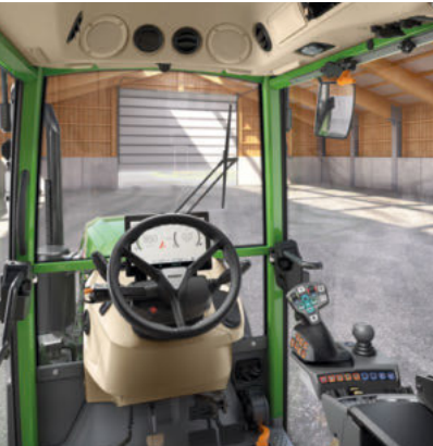
Profi Setting 1 - Krydshåndtag - 2 linearmoduler (vippeknap) til styring af hydraulikventiler
