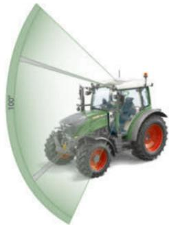
La ventana del techo integrada ofrece una excelente visión con un sorprendente ángulo visual de 100°. Esto le proporciona una visibilidad sin obstáculos, desde el cargador frontal levantado hasta los pasos de rueda.
