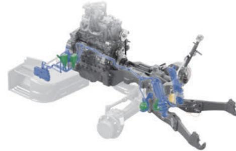
El elevador hidráulico delantero está totalmente integrado e instalado cerca del vehículo. Esto hace que las máquinas conectadas sigan siendo muy maniobrables. Los brazos inferiores presentan un agarre inferior y pueden plegarse para el estacionamiento. Los fuelles protegen los cilindros de elevación frente a los impactos de piedras. La amortiguación de oscilaciones instalada de estándar evita el rebote y garantiza una conducción segura y cómoda.
