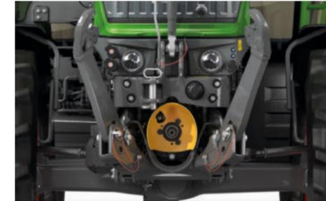
Los acoplamientos hidráulicos en la parte trasera están perfectamente alineados y codificados por colores. Los tapones antipolvo se cierran solos. Las conexiones están desplazadas para un fácil acoplamiento y, además, se desacoplan bajo presión.
