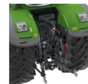
Hátsó emelőmű gyorskapcsoló horgokkal a vonókarokon
