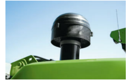
• Syklonforfilter for luftfilter (utskillingsgrad 98 %)
