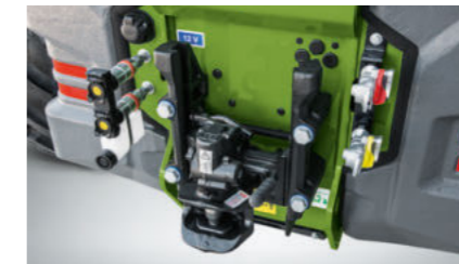
• Automatische trekhaak (Rockinger) • Max. aanhangerbelasting 18,5 t
