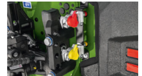
Opbouw – Opties • Luchtdrukremstelsysteem
