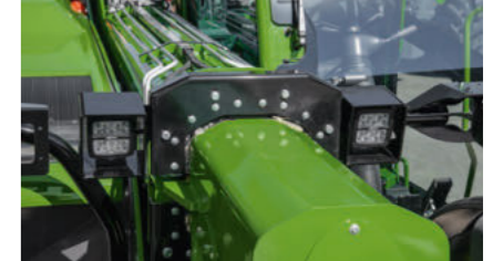
Teleszkópkar LED világítás
