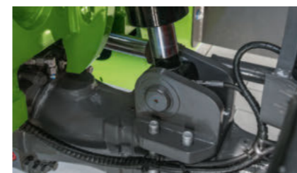
Futómű – Opciók Lengőtengely reteszelés a hátsó tengely számára • 1. funkció: szabadon leng • 2. funkció: automatikus aktiválás álló helyzetben • 3. funkció: folyamatosan zárt
