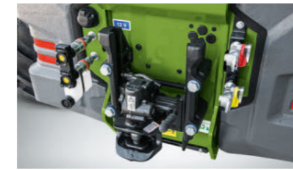
• Automata pótkocsi vonófej (Rockinger) • A maximális vontatott teher 18,5 t
