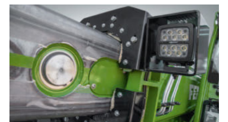
Raclleur • Diminue la pénétration de saleté à l'intérieur de la flèche télescopique et protège de l'usure prématurée et des dommages
