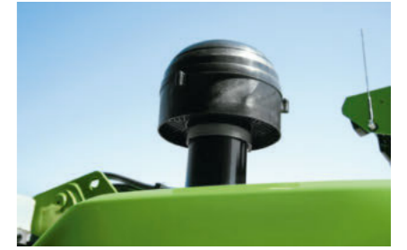
• Syklonesierotin ilmansuodattimelle (erotusaste 98 %)
