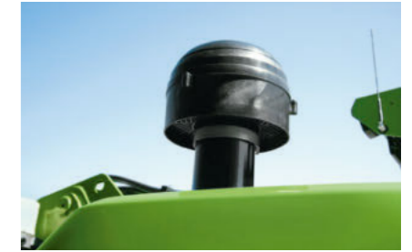
• Preseparador Cyclone previo para el filtro de aire (grado de separación del 98 %)
