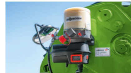
Lubricación central • Lubricación de todos los puntos, incluso aquellos en el cabezal del brazo telescópico
