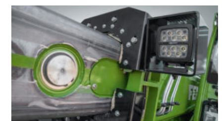
Afskraber til snavs • Forhindrer snavs i at trænge ind i teleskopudlæggeren samt beskadigelser
