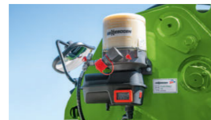
Central smøring • Forsyning af alle smørepunkter, herunder på teleskophovedet
