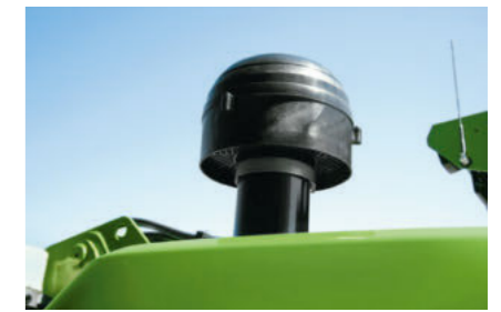
• Cyklonforseparator til luftfilter (udskilningsgrad 98 %)
