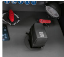
■ OptiFlow juhtimiskeskus: kemikaalidosaatori kõrvale paigutatuna saab sellel juhtida segamisseadme ja lahusepaagi täitmise kõiki funktsioone.
