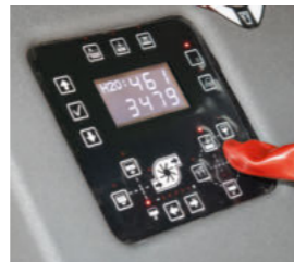
■ OptiFlow juhtimiskeskus: kemikaalidosaatori kõrvale paigutatuna saab sellel juhtida segamisseadme ja lahusepaagi täitmise kõiki funktsioone.
