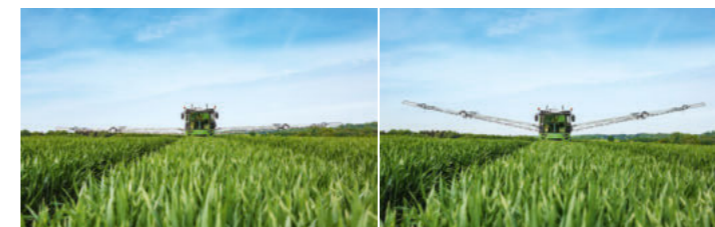
Poomi positiivne ja negatiivne nurk põllul tagab alati optimaalse laotuskõrguse hoidmise.
