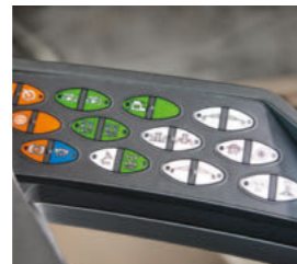
■ Peegeldusvaba taustvalgustusega ja kilekattega klahvistik tagab pideva usaldusväärse juurdepääsu kõigile funktsioonidele
