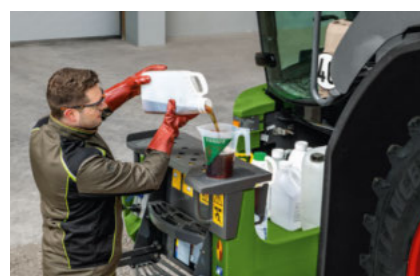
• Compartimento de almacenamiento para productos fitosanitarios
