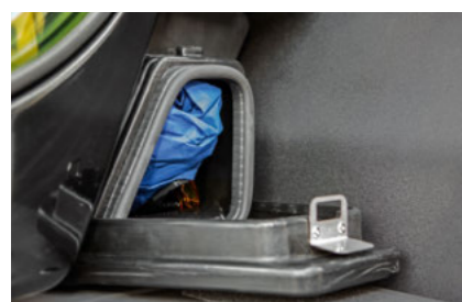
• Compartimento de almacenamiento para guantes y ropa de protección • Mantiene el PPE alejado de la cabina con certificado Cat 4
