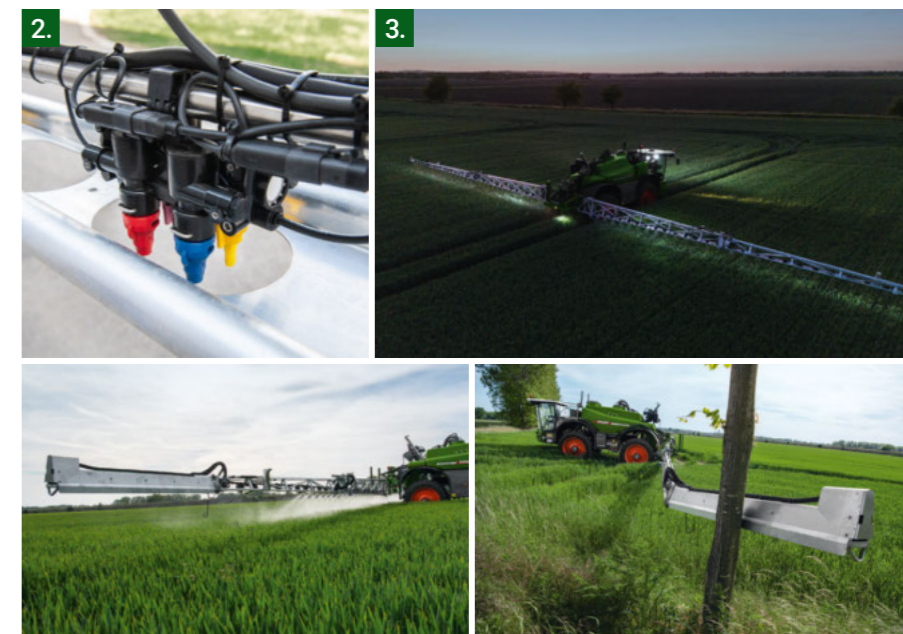
Construcci3n trapezoidal de la barra Boquillas completamente protegidas
