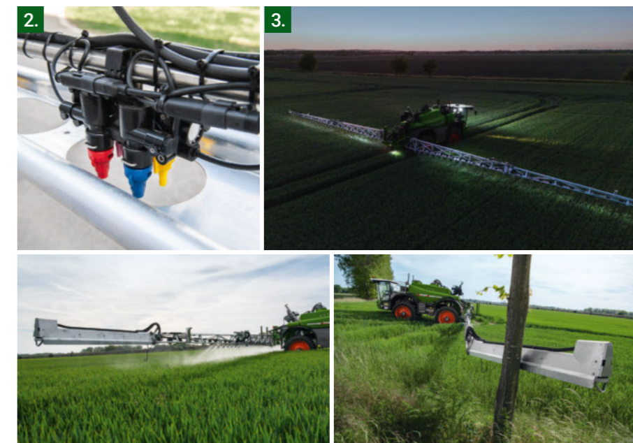
Trapezförmige Balkenkonstruktion Düsen vollständig geschützt
