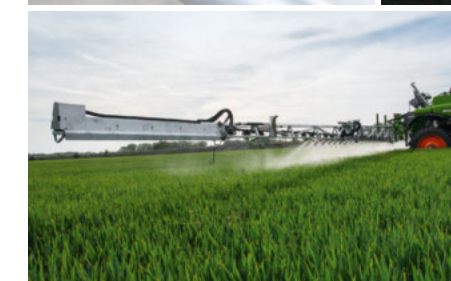
Trapezformet konstruktion Dyser helt beskyttet
