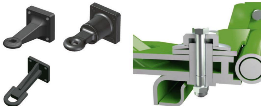
□ Ob Zugöse starr, Zugöse drehbar oder Hitchhaken – beim Fendt Twister haben Sie die Wahl. (Fendt Twister 11008 T und 13010 T)
