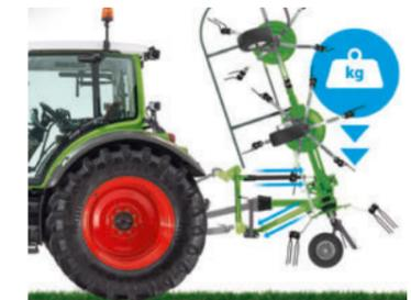
Das patentierte Druck-Zug-System sorgt für beste Boden Anpassung und optimales Nachlaufverhalten dank tief liegendem Zugpunkt.
