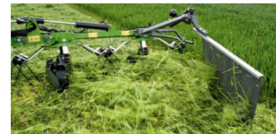
Beim Topmodell Twister 11010 DN erfolgt das Randstreuen über ein optionales Randstreutuch, das hydraulisch klappbar ist.
