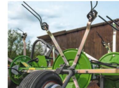
Durch die geschlossene Bauweise sind die Kreiselköpfe der Fendt Twister zuverlässig vor Staub und Schmutz geschützt.
