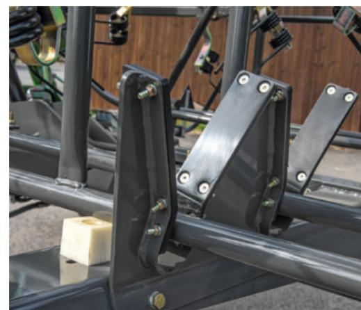
■ Perfekt abgelegt werden die Twister Schutzbügel in die speziellen v-förmigen Halterungen am Rahmen, die mit langlebigen Gleitelementen ausgestattet sind. (Nur bei Fendt Twister mit Transportfahrwerk.)
