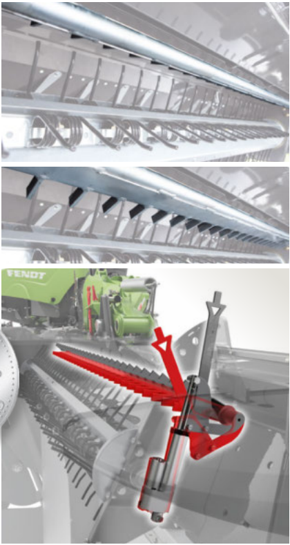
DLG prisbelönt och steglöst automatiskt system för efterbehandlingsintensitet med ISOBUS-klipparkombinationer
