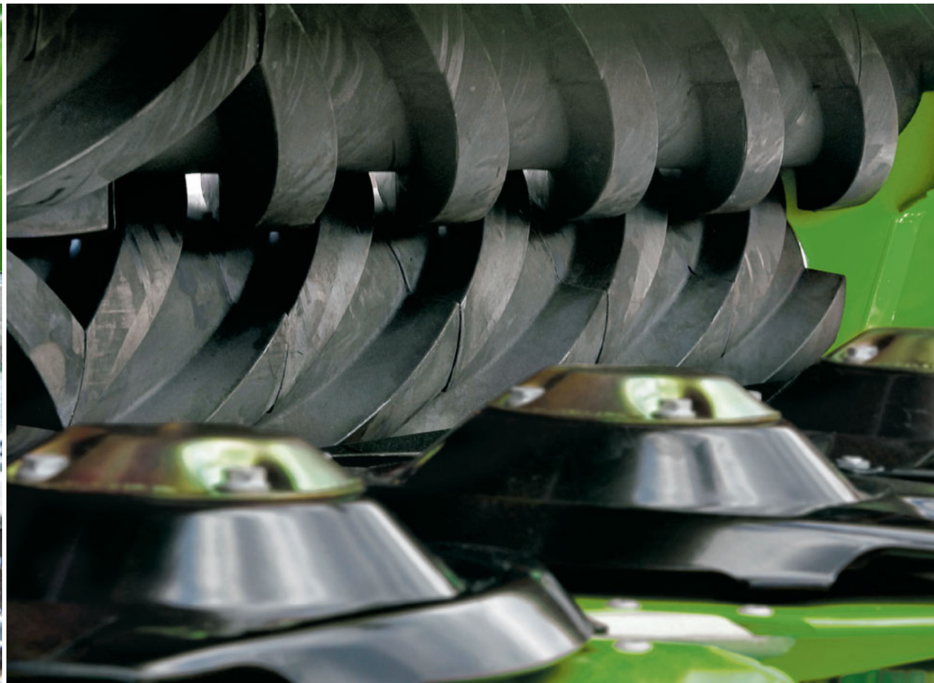
Valskross: baljväxter såsom lusern och klöver. Arbetar mer skonsamt än rotorkrossen.
