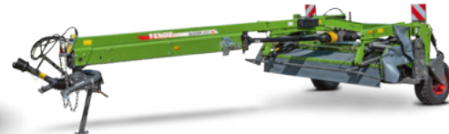
Dragna slåtteraggregat med transportchassi Hög flexibilitet med rotor- eller valskross Arbetsbredd 3,00 m
