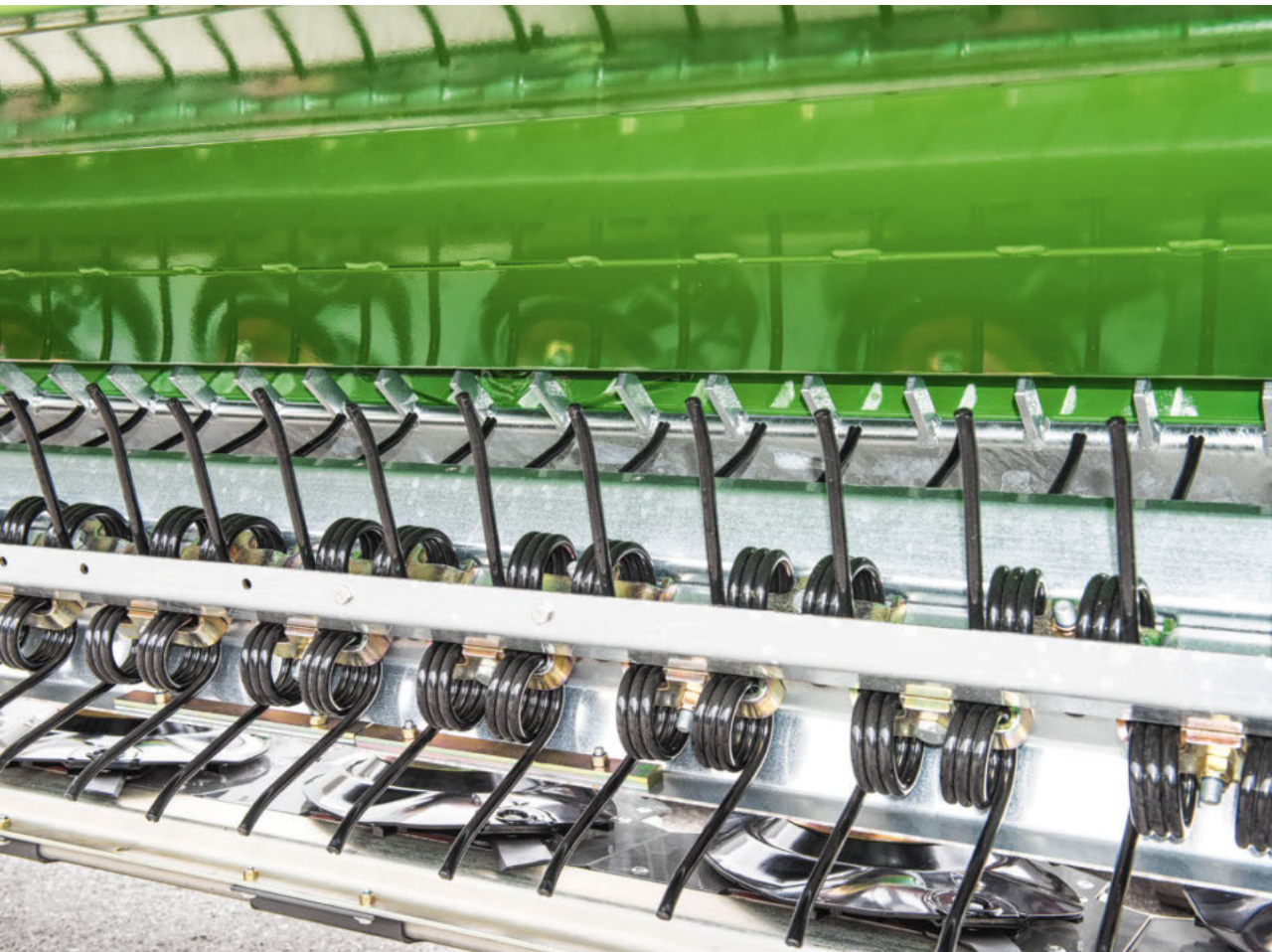
Rotorkross: Mer aggressiv än valskross. Gräsbestånd, fältfoder etc.
