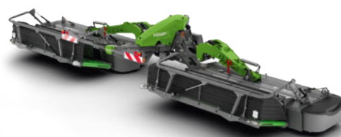
Kombinasjoner med ISOBUS Stengelbehandlere med full automatisering, med og uten transportbånd Arbeidsbredde 9,30 – 10,10 m
