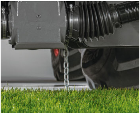
Genialt enkelt: En kjetting viser riktig transporthøyde – den kan lett ses fra førerhuset
