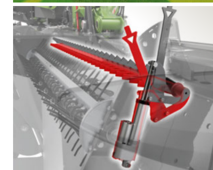
En elektrisk motor styrer motstålet på stengelbehandleren trinnløst; den regulerer intensiteten i behandlingen
