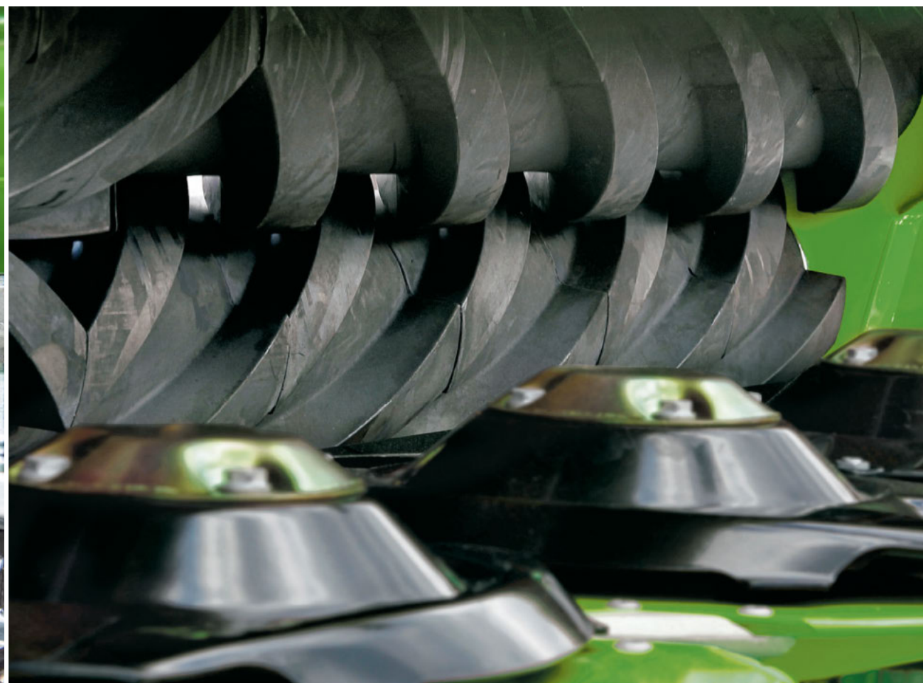
Valsebehandler: f.eks. alfafa og kløver. Arbeider mer skånsomt enn tinde-stengelbehandler.
