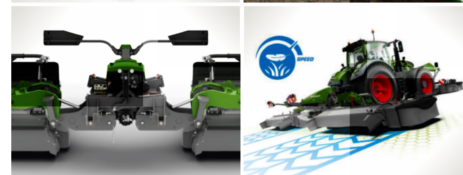
De PRO-modellen beschikken over het snelheidsafhankelijke TurboLift-systeem
