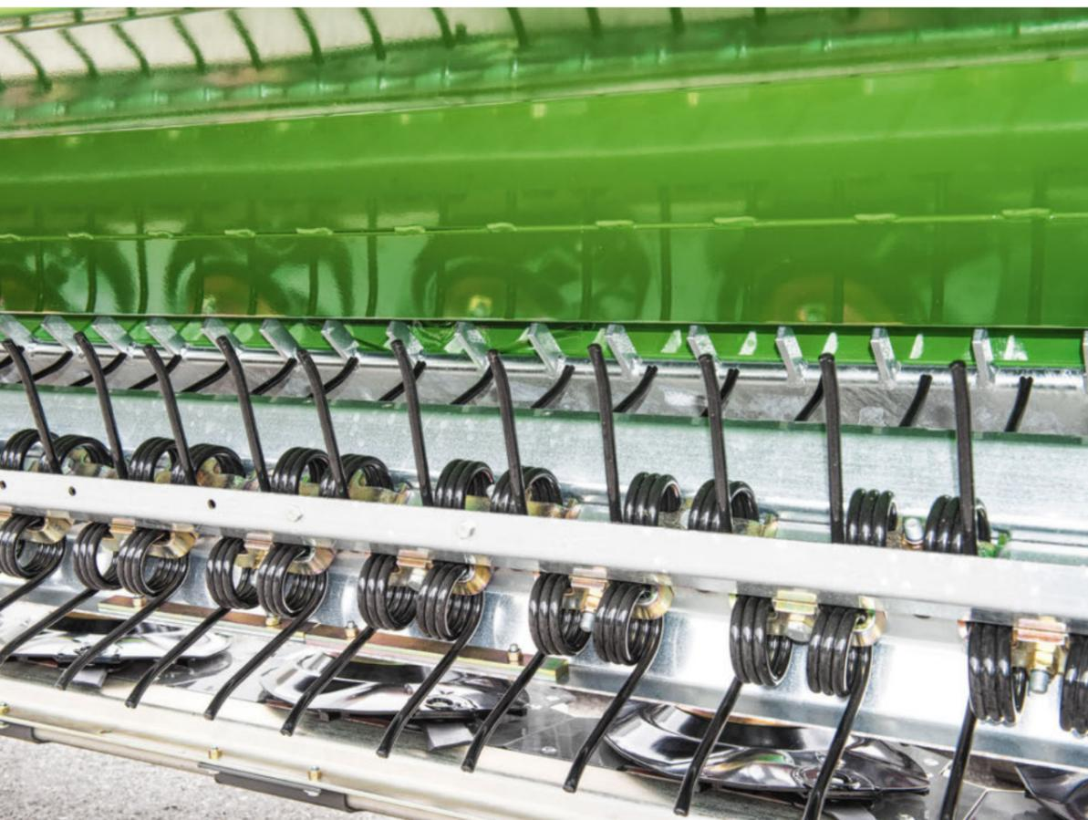
Conditionneur à dents : plus agressif que le conditionneur à rouleaux. Herbages, fourrage, etc.
