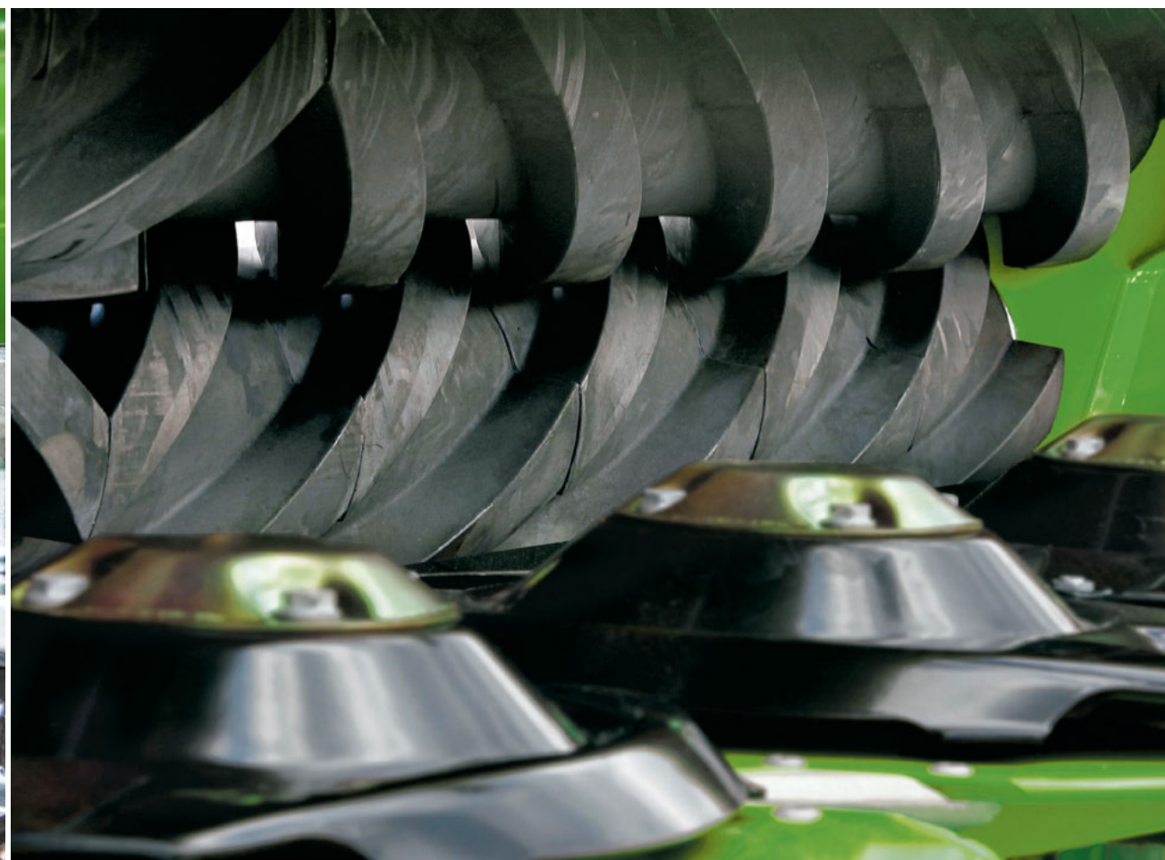
Telamurskain: Palkokasvit kuten sinimailanen ja apila. Toimii hellävaraisemmin kuin piikkimurskain.
