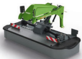
Vedava 3D ühendusraamiga esiniidukid Optimaalne kasutamiseks niidukombinatsioonis Töölaius 3,10 – 3,60 m
