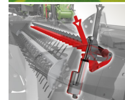
Elmotoren styrer trinfrit modkammen på crimperen, der er ansvarlig for crimplingens intensitet
