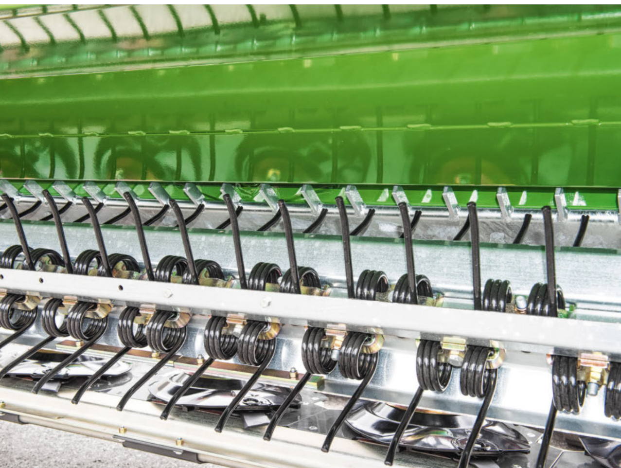
Fingercrimper: Fingercrimperen er mere aggressiv end valsecrimperen. Græsbestande, agerfoder, etc.
