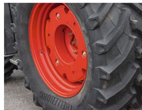
Le zavorre ad uso universale completano la zavoratura e la stabilità contro il ribaltamento.
