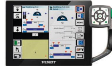
Il terminale Vario e il computer di lavoro sul caricatore frontale sono collegati tramite la presa CargoProfi.
