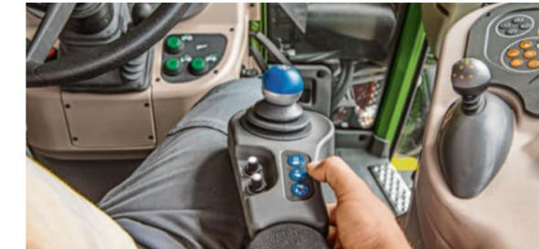
In capezzagna o durante i lavori di caricamento frontale, lo sterzo VarioActive permette di ottenere una rotazione completa della ruota con una sola rotazione del volante. Fino a 8 km/h il sistema di sterzo sovrapposto è illimitato, da 8 a 18 km/h l'effetto di sovrapposizione è lineare.
