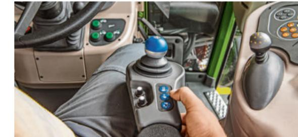
Am Vorgewende oder bei Frontladerarbeiten profitieren Sie von der VarioActive Lenkung, weil Sie mit nur einer Lenkradumdrehung bereits den vollen Radeinschlag erreichen. Bis 8 km/h hat die Überlagerungslenkung keine Einschränkung, ab 8 bis 18 km/h reduziert sich die Überlagerungslenkung linear.
