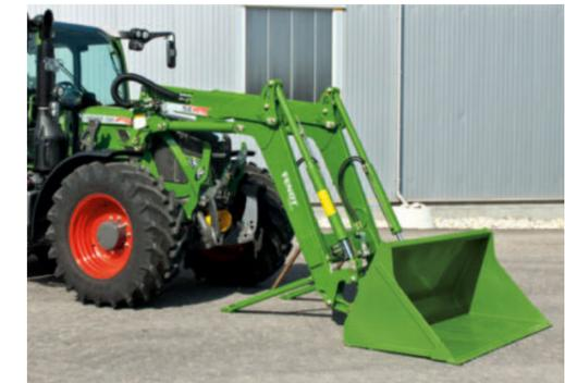
Fendt Cargo-Lock garantiert ein schnelles und einfaches An- und Abkuppeln. Der Multikuppler dient zum Anschließen aller hydraulischen und elektrischen Leitungen – frontladerseitig auch unter Druck.
