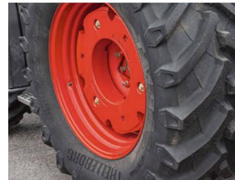
Universell verwendbare Gewichte perfektionieren die Ballastierung und Standsicherheit.
