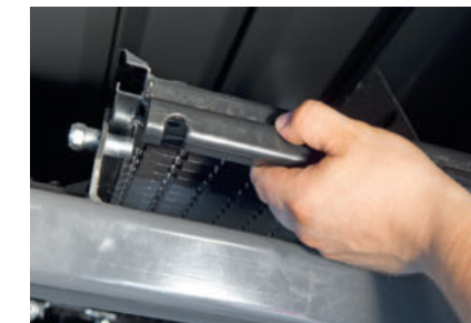
Rimozione dei crivelli
