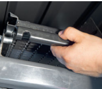
Rimozione dei crivelli
