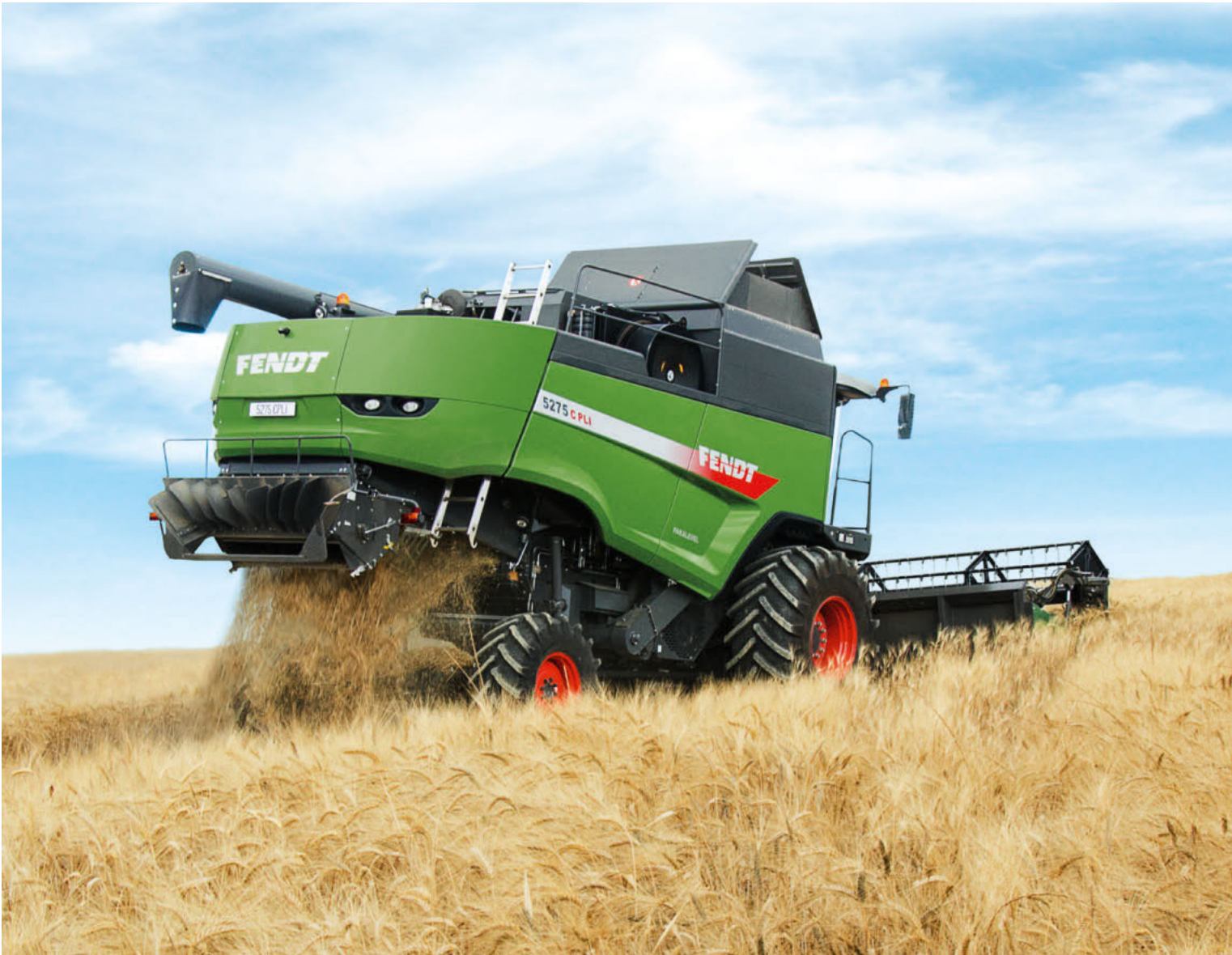
L'inclinazione longitudinale della macchina viene compensata da 2 robusti cilindri idraulici, che sono collegati al telaio separato dell'assale posteriore.
