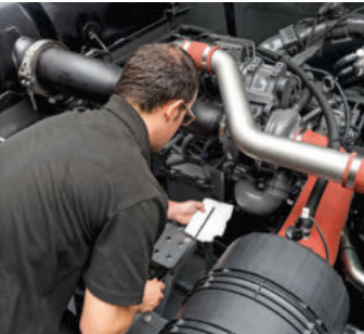
Controllo dei livelli di riempimento
