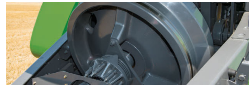
Az 545 kg-os lendkerék nagy erőátvitel mellett biztosítja a bálázó egyenletes és csendes működését.
