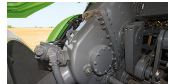
Új, nagy teljesítményű hajtóművet használnak az XD bálázóban. Összességében az XD hajtóműv 35%-kal nehezebb, mint a standard modell, ezért még nagyobb tömörítési nyomást képes létrehozni.
