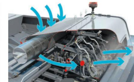
El ventilador transversal estándar mantiene un flujo constante de aire a toda la zona de los atadores, eliminando a fondo los residuos y la suciedad.
