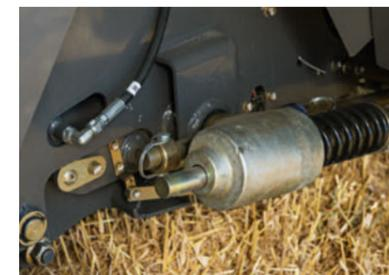
La altura de recogida se ajusta sin necesidad de herramientas – basta con elevar el pick-up e introducir el pasador en el orificio adecuado.
