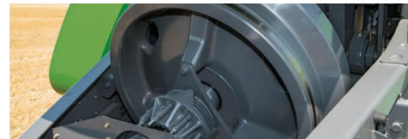
El volante de la empacadora de 545 kg permite un funcionamiento suave y uniforme, a la vez que garantiza una alta transferencia de la potencia.
