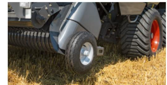
Las ruedas de control impiden que el pick-up descienda demasiado y aseguran una limpia recogida del cultivo. Estas pueden desmontarse para el transporte.
