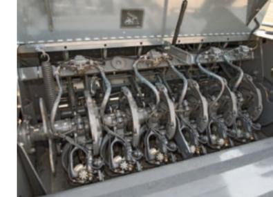
Un gran capó para mantenimiento y el ventilador transversal abatible facilitan el acceso a los atadores.
