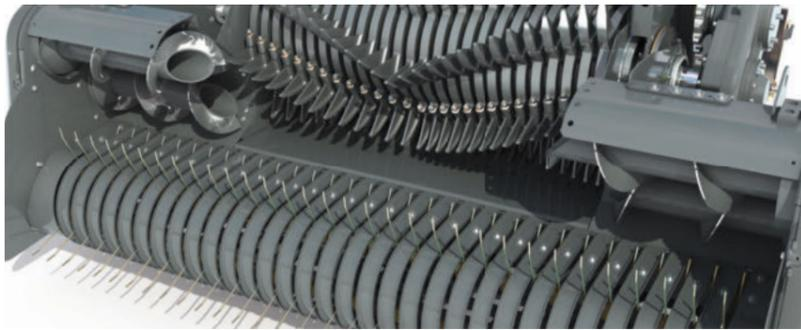
Los sinfines de centrado adicionales garantizan una recogida uniforme del cultivo y un llenado óptimo de la cámara de pre-compresión.
