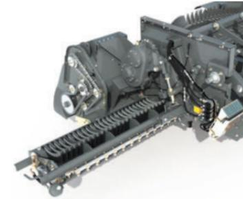
Cuchillas del Rotor Cutter dispuestas en "V" con los segmentos de púas de rotor atornillados. Una alta velocidad de 120 rpm asegura una alta frecuencia de corte y mejor rendimiento del sistema de picado con la mejor calidad de corte.
