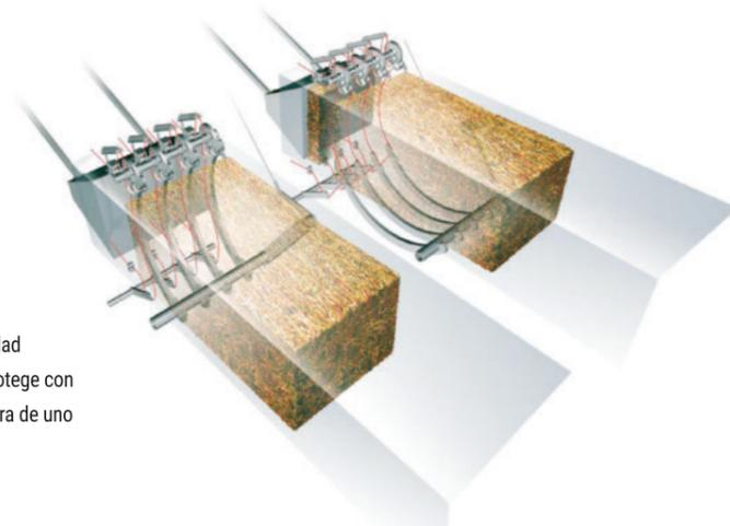
Nada se deja al azar. Una barra de seguridad conectada al accionamiento del pistón protege con total seguridad las agujas en caso de rotura de uno de los fusibles de seguridad.
