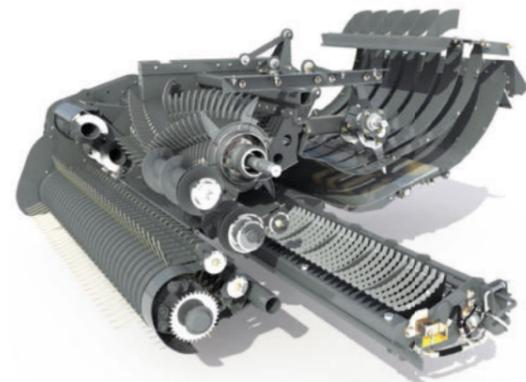
El bastidor inferior donde se alojan las cuchillas de corte puede extraerse desde el lado izquierdo de la máquina para el reemplazo de las cuchillas.
