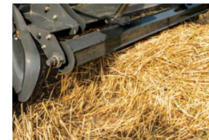
La cubierta deflectora y el rodillo de presión aseguran un flujo uniforme del material hacia la empacadora.
