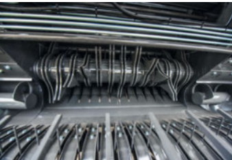
Rotor XtraCut13 (avstånd mellan fingerpar: 90 mm) - Utan skärenhet (standard) - Med skärenhet: Upp till 13 knivar
