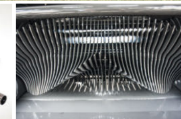
XtraCut25 rotor - Szeletelőszerkezet : akár 25 kés
