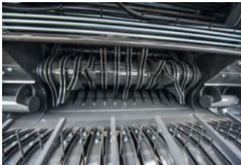
XtraCut13 rootor (teisdussõrmede paari samm: 90 mm) - Ilma peenestusmehhanismita (seeria) - kuni 13 noaga peenestusmehhanism
