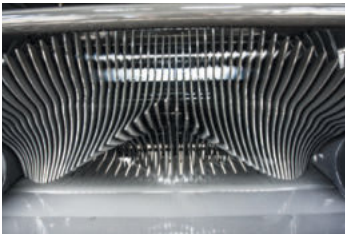
XtraCut25 Rotor - Mit Schneidwerk: bis zu 25 Messer
