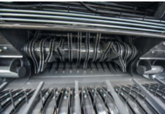
XtraCut13 Rotor (Afstand fingerpar: 90 mm) - Uden snitter (standard) - Med knivbjælke: op til 13 knive
