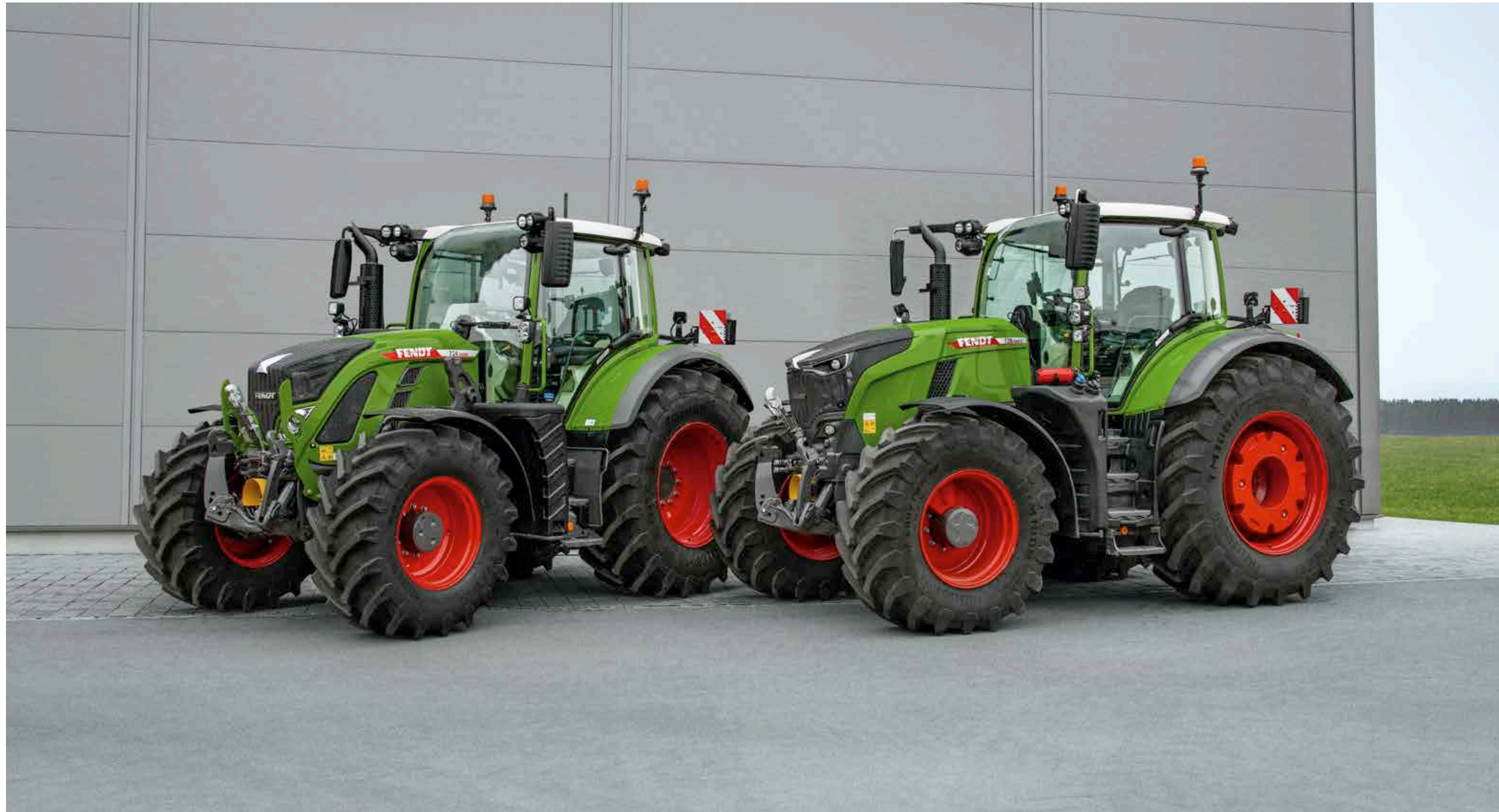
Fendt 724 Vario Gen6: Bereifung vorne – 600/65 R28; Bereifung hinten – 650/75 R38 Fendt 728 Vario Gen7: Bereifung vorne – VF 600/70 R30; Bereifung hinten – VF 710/70 R42
