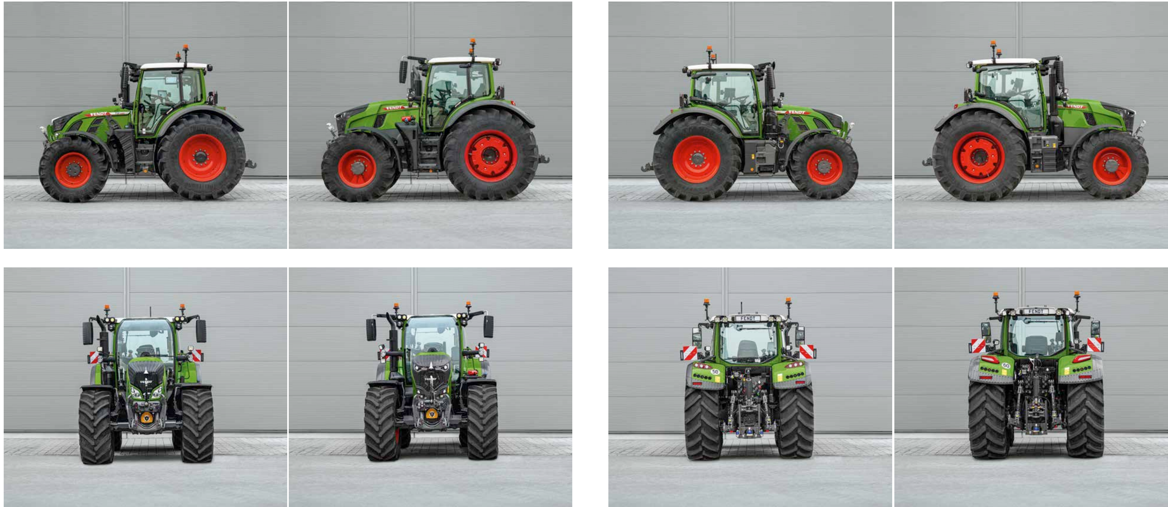
Fendt 724 Vario Gen6: Bereifung vorne – 600/65 R28; Bereifung hinten – 650/75 R38 (Durchmesser von 1,95 m)
