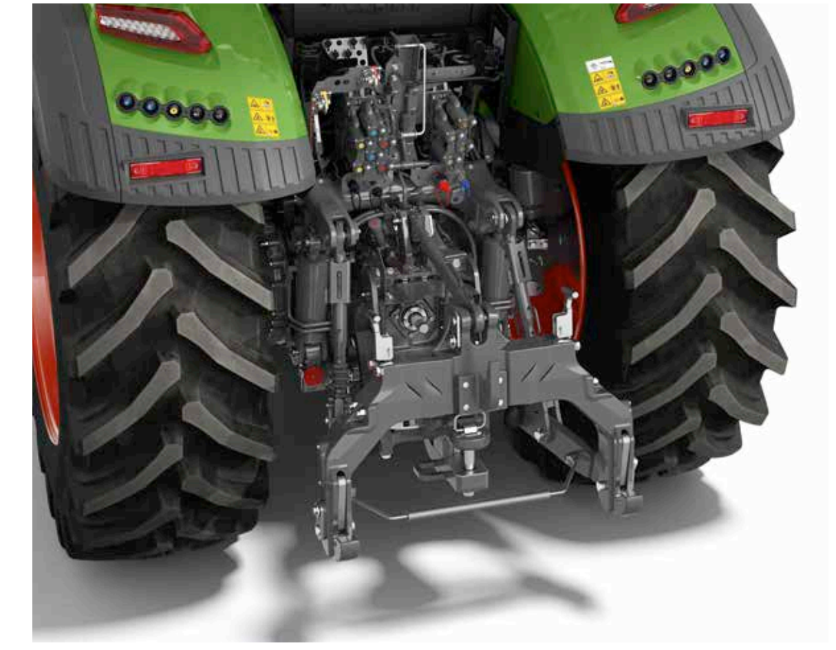
Quick Hitch-Rahmen mit serienmäßiger hydraulischer Öffnung der Fanghaken
