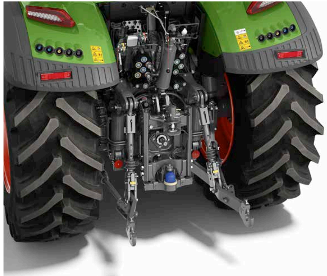
Heckkraftheber mit Schnellfanghaken und Seitenabstützung (EU)
