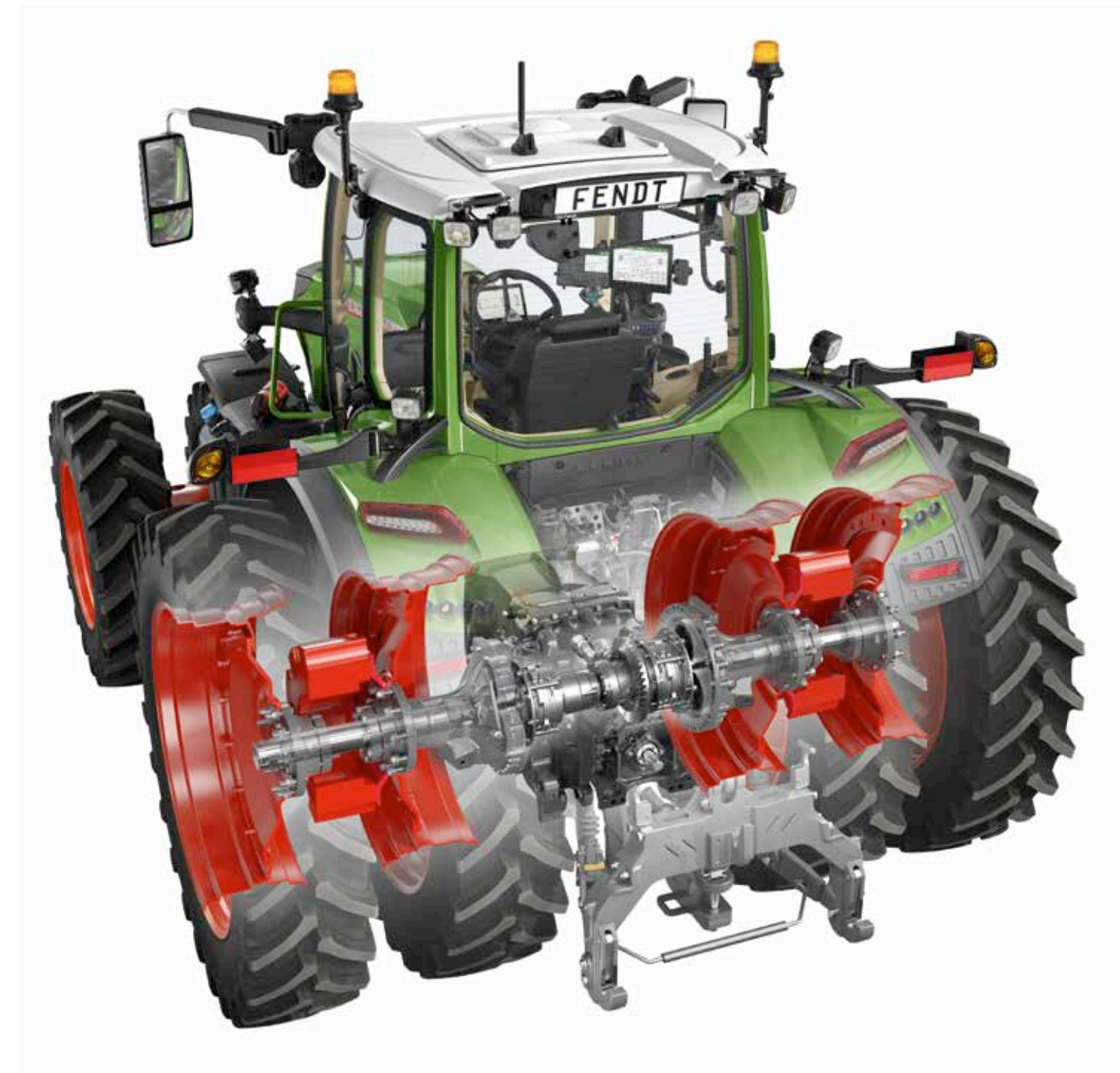
Stummelhinterachse 2.500 mm Zwillingsräder mit Duoradnabe
